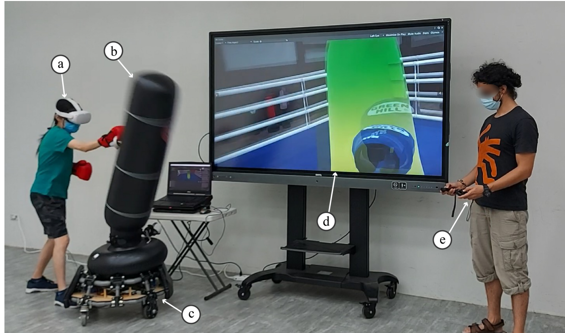
Fig. 1. VR 模擬拳擊應用展示: a) 選手, b) 輔具沙包, c) MovableBag 底盤, d) 選手視覺-VR 顯示器的畫面, e) 教練
